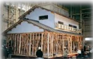
原子力工学試験所における木造実物大振動実験をはじめ、阪神淡路大震災の震源地においても安全性が確認されるなど、JOTOキノパッキング工法は、様々な角度から信頼性が保証されている工法です。水平保持耐力（横スベリに対する強さ）は、建築基準法に定められた数値を大幅に上回り、経年変化についても、多数の実験と実地データから安全性が確認されております。
