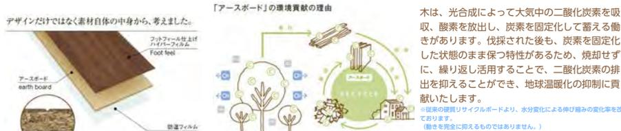
建築廃材を再利用してつくられた「アースボード」を基材として使用しています。アースボードとは、住宅・住設機器などを解体した際に発生する建築廃材をチップ化し、選別したうえで、耐水性の高い接着剤で固めた「木を循環させて使う」リサイクル材料です。
