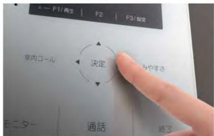
モニター付親機のボタン部分に、「静電式タッチセンサー」を搭載。従来のボタンを“押す”感覚と異なり、指先で“軽くふれるだけ”の操作感が特徴です。よく使うボタンは常に見えるよう配置し、使いやすさにも配慮しました。
