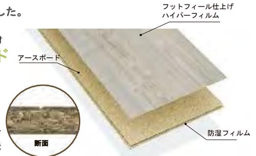
建築廃材を再利用してつくられた「アースボード」を基材に使用しています。住宅・住設機器などを解体した際に発生する建築廃材をチップ化し、選別したうえで、耐水性の高い接着剤で固めた“木を循環させて使う”基材です。合板よりも硬くて強い基材を実現します。
