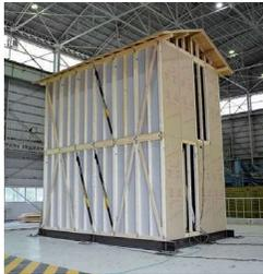
実大2階建住宅の振動台実験
